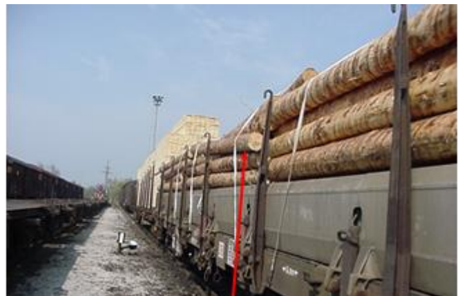
Dieser Stamm wird nur von einer Runge gehalten!
