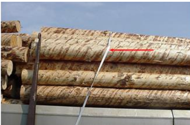
Der Spanngurt ist nicht gerade gebunden!
